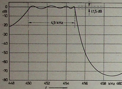
Bild 13. Einseitenbandfilter für 450...455 kHz mit drei entdämpften Kreisen.
